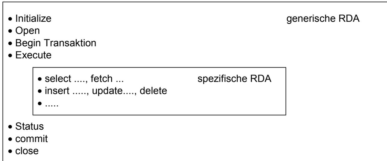
Die Implementierung eines RDA ist in den Schichten 5 (session layer) und 6 (presentation layer) des OSI-Modells angesiedelt und bedeutet die Installation zusätzlicher Software auf Client- und Serverseite.
